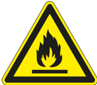
Fig. 5 Warnzeichen «Feuergefährliche Stoffe»
